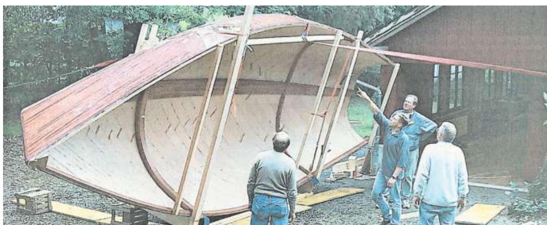
Mit Seilen gesichert drehten Christian und Balz Kunz zusammen mit ihren Helfern die Schale ihres Segelschiffs.
