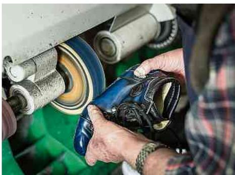
Abschleifen, bevor eine neue Sohle an den Schuh kommt.
