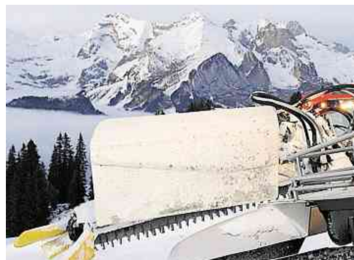
Der zusammengeschobene und plattgedrückte Schnee wird mit der Fräse weiterbearbeitet. Das Resultat sind die Rillen im Schnee.
