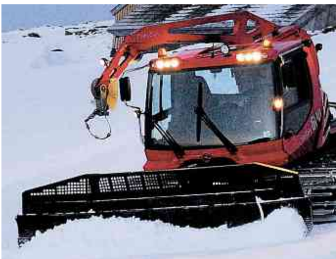
Mit dem Schild vorne am Fahrzeug wird der Schnee zusammengeschoben. Oberhalb der Führerkabine ist der Arm der Seilwinde.
