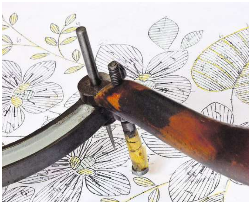
Ein Stickmotiv, das mit dem Pantografen nachgezeichnet wird.
